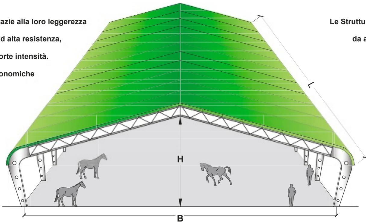
Le Strutture Metalliche sono costituite da aste sciolte e piastre di nodo in acciaio ad alta resistenza. La produzione è robotizzata. I manufatti metallici sono così molto economici. Il costo delle fondazioni grazie alla leggerezza delle strutture e con l'impiego dei supporti viti / trivelle è molto economico.
